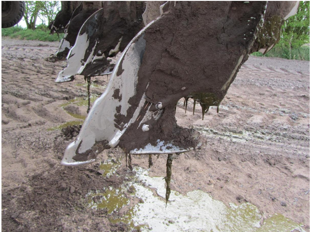
Harvetand på Horsch Focus SC. Gyllen placeres efter vingskæret.
