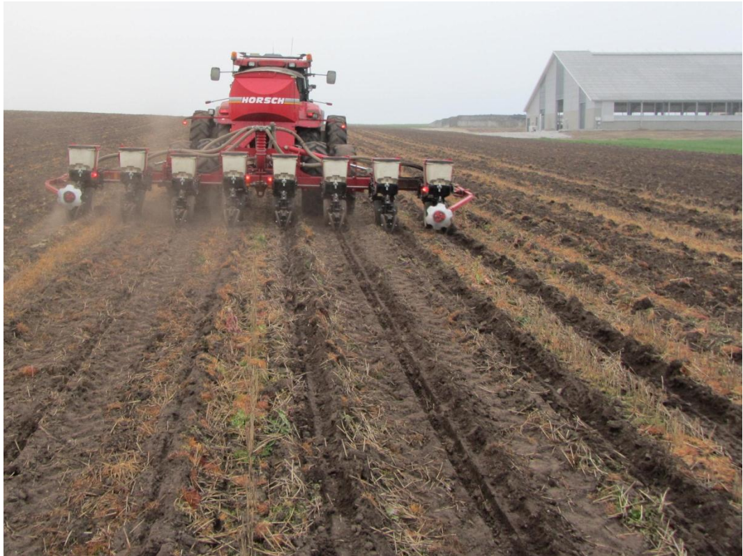
Såning i rækkerne, hvor jorden er stribebehandlet ved gylleplacering.
